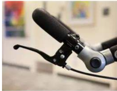
Hình: Các dạng phanh/khoá bánh xe lăn
